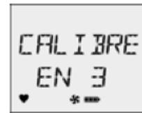
3. **AUTO-ZERO** parpadea mientras el detector pone automáticamente todos los sensores en cero y calibra el sensor de oxígeno. Si un sensor presenta un error al realizar el cero automático, no se puede realizar su calibración. Una vez que se ha completado el cero automático, la pantalla LCD indica AGREGAR GAS (Aplicar gas).
