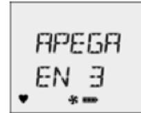
2. El detector se vuelve a activar y ejecuta la cuenta regresiva de CAL (Calibración). Mantenga presionado
