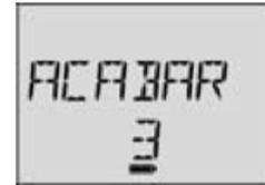
2. El detector se vuelve a encender y ejecuta la cuenta regresiva de **CALIBRE**. Mantenga presionado
